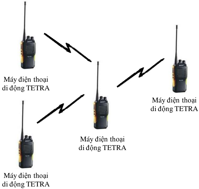
Hình 6 – Chế độ trực tiếp (DMO) - Cuộc gọi nhóm giữa các máy điện thoại di động (điểm-đa điểm).
