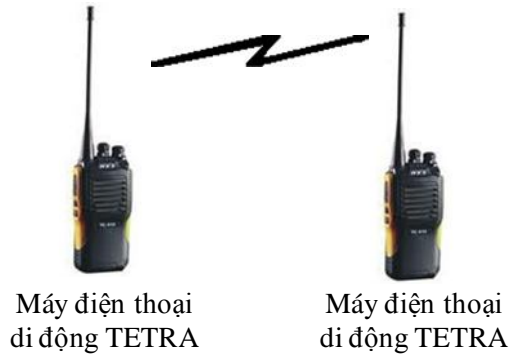
Hình 5 – Chế độ trực tiếp (DMO) - Cuộc gọi riêng lẻ giữa hai máy điện thoại di động (điểm-điểm)
