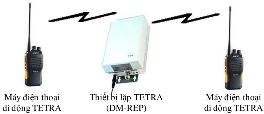
Hình 7 – Chế độ trực tiếp (DMO) - Cuộc gọi qua thiết bị lặp.
